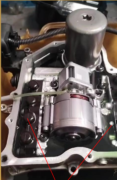
Verificación de fugas por burbujas en el fluido hidráulico.
