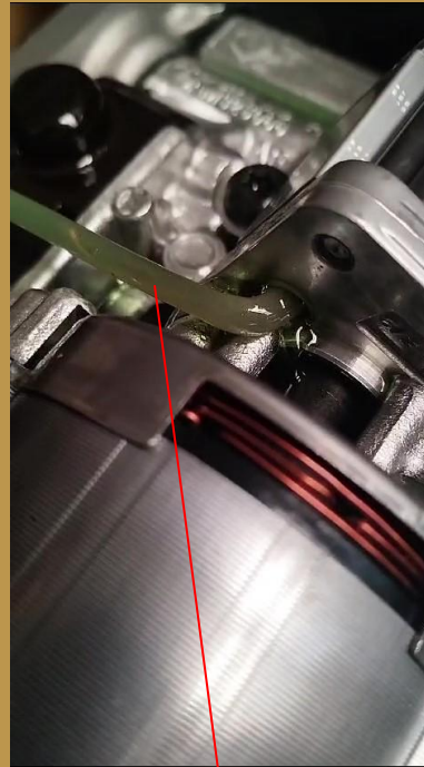
Alimentación de fluido hidráulico.
